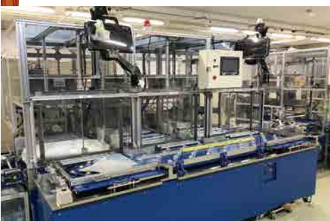
車載インバータ試験装置 ハイブリッド車に搭載されるインバータの性能試験を行う装置です
